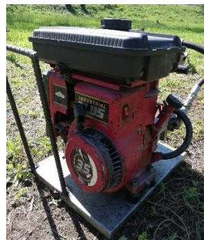
(b) Gerador de apoio ao sistema hidráulico
