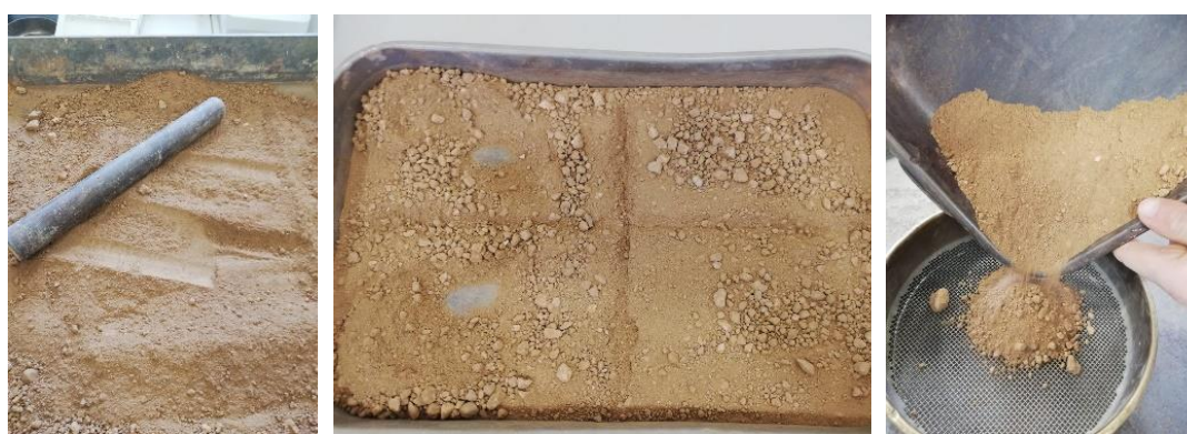
(a) Desterroamento manual (b) Seccionamento e seleção pelo método dos quartis (c) Peneiração
