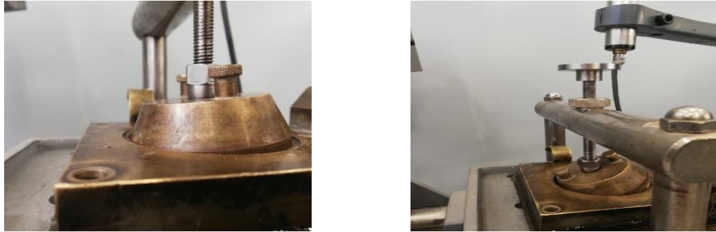
Figura 43 - Rotação do topo do provete devido ao aumento de tensões horizontais de corte
