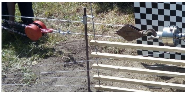
(a) Sistema adotado para desmultiplicação da força
