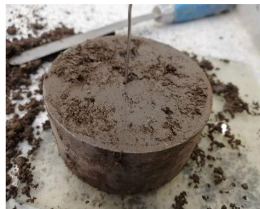
Figura 44 - Inspeção não destrutiva dos provetes extraídos
