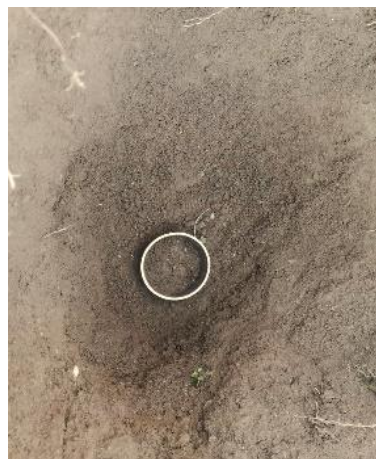
(a) Cravação de anel metálico
