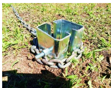
(a) Prumos reação dos ensaios estáticos
