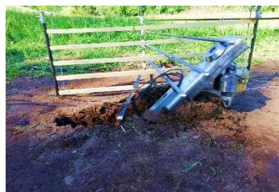
(b) Vista lateral da deformação final prumo P3
