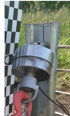
(c) Célula de carga principal no topo do prumo
