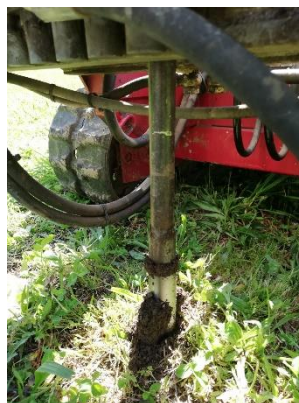
(h) Fase secundária de cravação da ponteira dilatométrica
