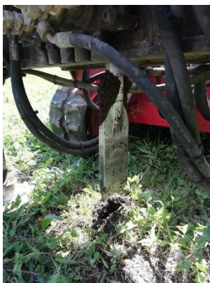
(g) Fase primária de cravação da ponteira dilatométrica
