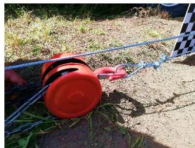
(b) Ligação guerdal com cabo de aço inoxidável
