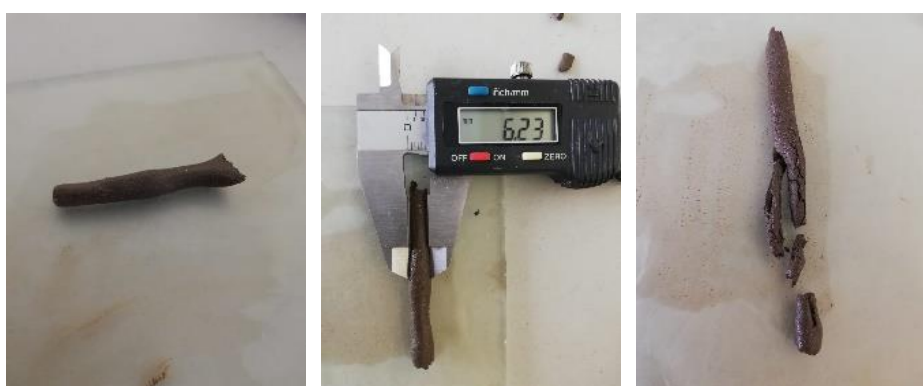
Figura 34 - Ensaio do de determinação do limite de plasticidade ( \omega_p )
