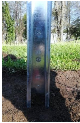
(a) Medalhas das células de carga com fixação mecânica
