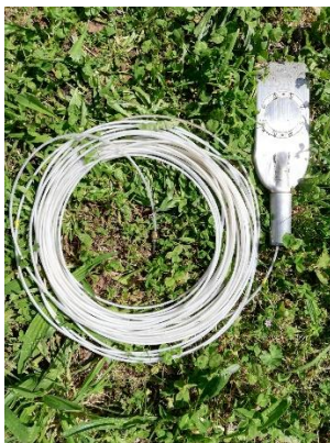
(d) Cabo pneumático-elétrico e ponteira dilatométrica
