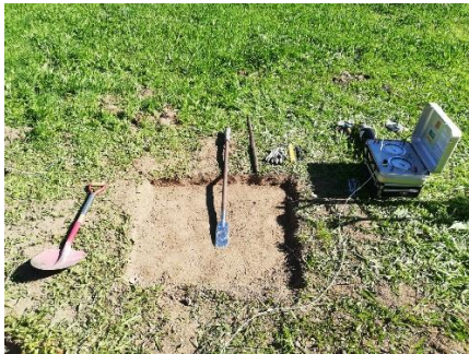
(a) Criação de plataforma de trabalho 80cm · 80 cm para execução de ensaio.
