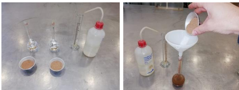
Figura 36 - Determinação da densidade das partículas sólidas
