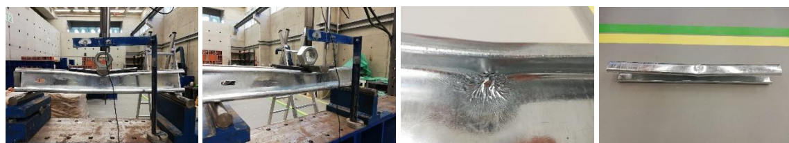
Figura 54 - Procedimento de ensaio ao prumo metálico segundo o eixo de maior inércia
