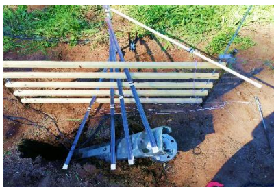
(a) Vista superior da deformação final prumo P3
