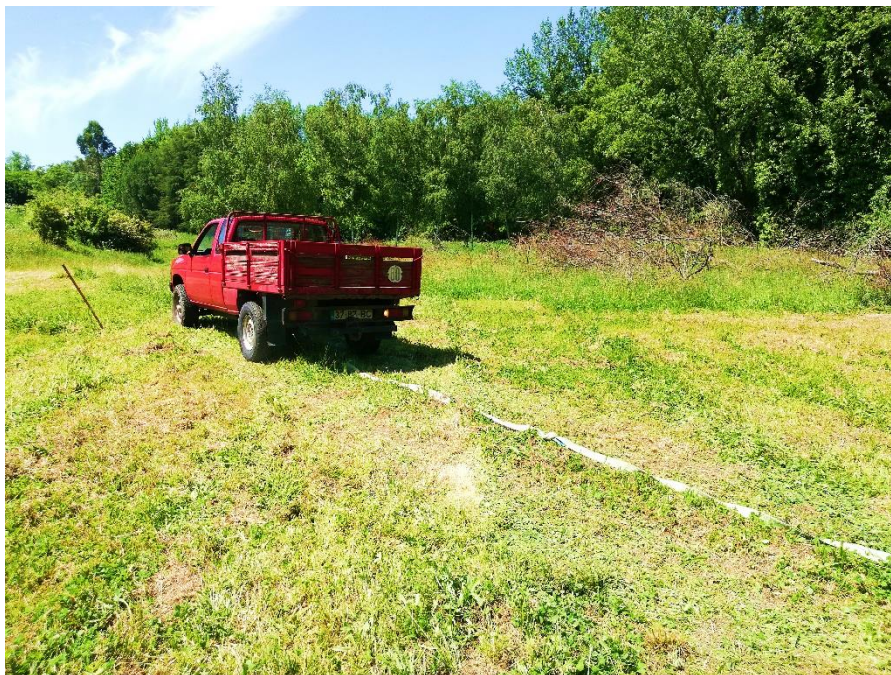
b) Veículo com cinta ancorada e alinhado com a direção de solicitação.
