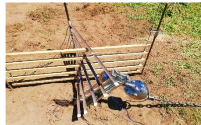
(d) Vista superior da deformação do prumo P6
