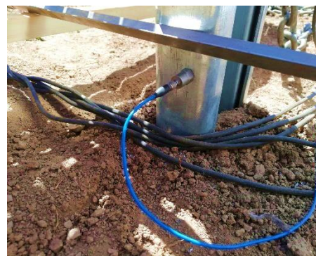
(c) Acelerómetro fixado mecanicamente ao prumo para registo das acelerações
