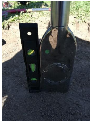
(b) Controlo de verticalidade da lâmina do DMT
