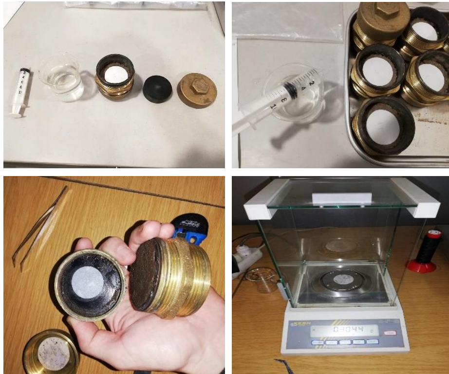
Figura 46 - Processo laboratorial do ensaio de sucção
