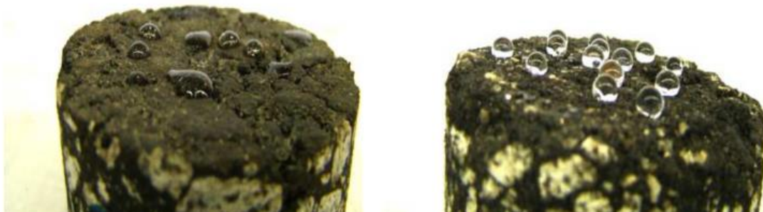
Figura 11: Diferença do ângulo de contato da mistura asfáltica nas misturas asfálticas: a) antes e b) após a aplicação do tratamento (NASCIMENTO et al., 2012)
