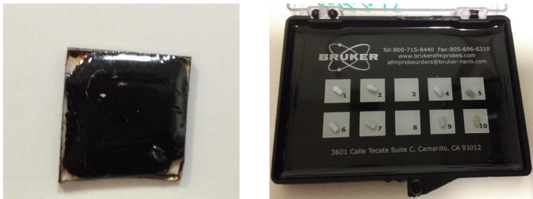
Figura 21: (a) Lamelas utilizadas para a análise do ligante asfáltico; (b) Sondas utilizadas no ensaio de AFM
