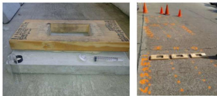
Figura 2: Procedimento de selagem e captação de solução de nitrato (OSBORN et al., 2014)
