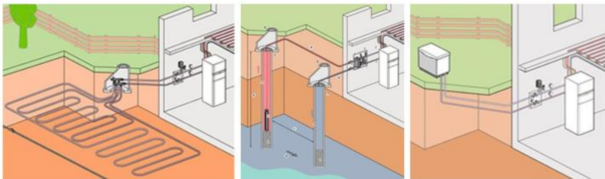
Figura 18 Izquierda: Sistema Tradicional, Centro: Sistema Subterráneo, Derecha: Sistema externo. Tomado de: (Vaillant, 2016)
