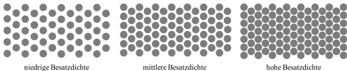
Abbildung 3-6 Darstellung der Besatzdichten anhand von Bohrlochabstände im Grundkörper bei gestopfter Fixierung, vgl. [64]
