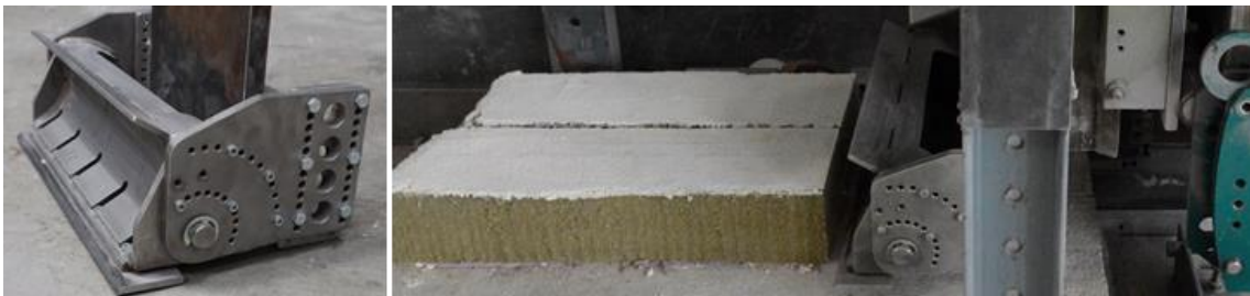
Abbildung 5-40 links: Schneide, rechts: Versuchsstand II mit vorgelagertem Schneidwerkzeug (WDVS-Aufbau 102)
