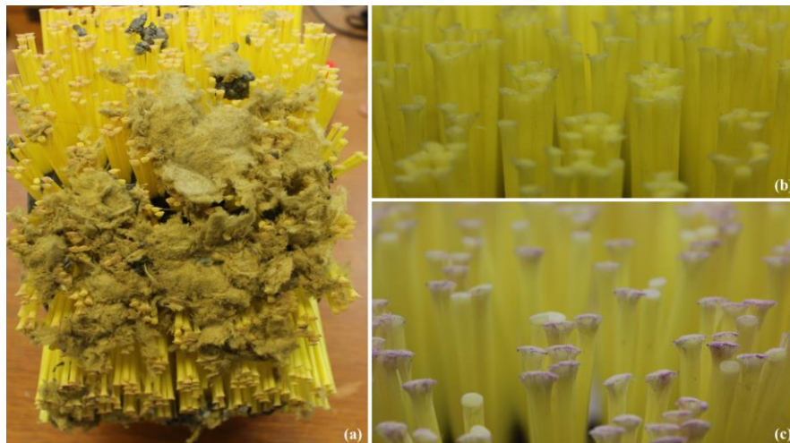
Abbildung 5-30 Aufnahmen Werkzeugtyp 104: (a) Bürste setzt sich zu; (b) Einzelspitzen vor Versuchsdurchführung; (c) Einzelspitzen nach Versuchsdurchführung
