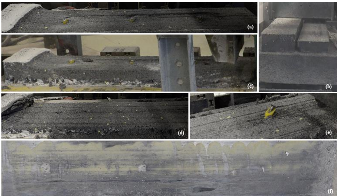
Abbildung 5-43 Exemplarische Aufnahmen der Abtragsergebnisse des Bürstentyps 101 bei mehrfacher Überfahrt des WDVS-Aufbaus 101 (Dämmstoff EPS inkl. Verdübelung), entstanden in Zusammenarbeit mit [132]
