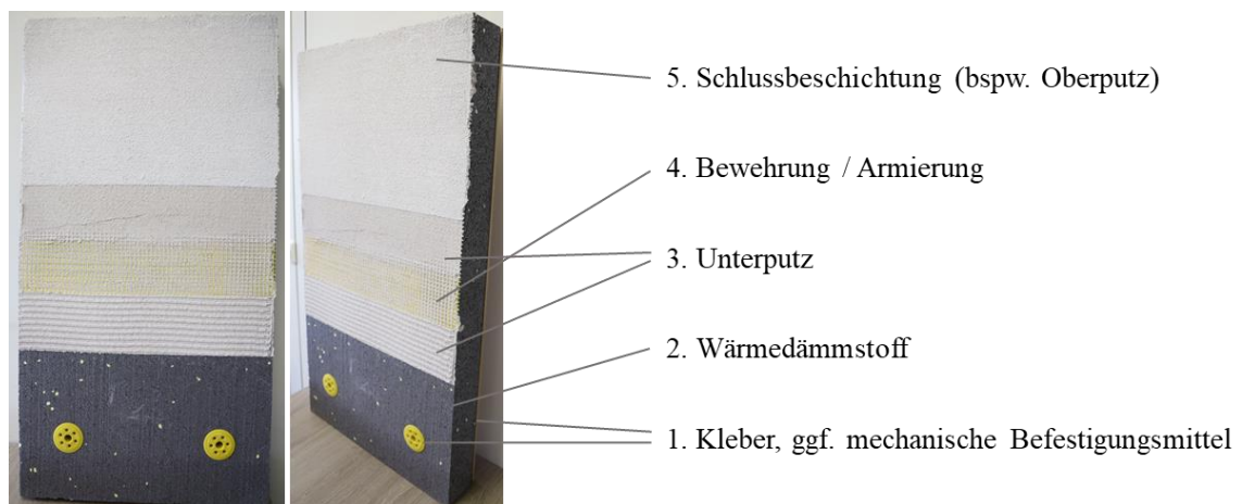
Abbildung 2-1 Exemplarischer Aufbau der Systembestandteile eines WDVS
