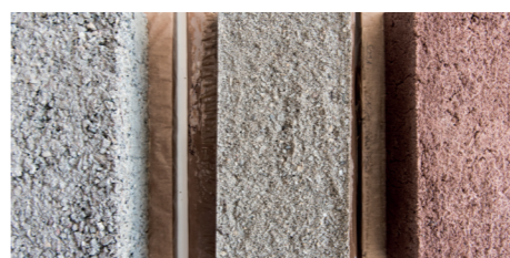
Die fertigen «Milchbeton»-Ziegel © Wojciech Zawarski
