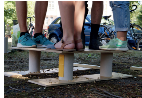
Belastungstest mit der „Bauschuttstütze“ © Sandra Böhm
