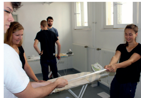
Belastungstest mit verschweissten Kunststofffolien © Sandra Böhm
