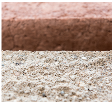
Die fertigen «Milchbeton»-Ziegel © Wojciech Zawarski
