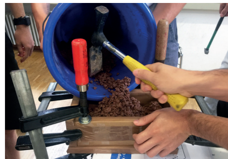
Die richtige Mischung finden – Mineralischer Bauschutt und frischer Ton © Sandra Böhm
