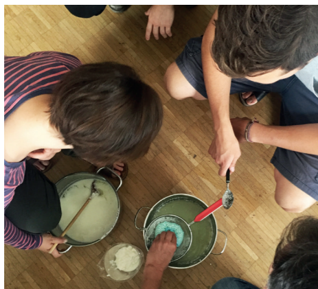
Herstellung von Kaseinkleber © Sandra Böhm
