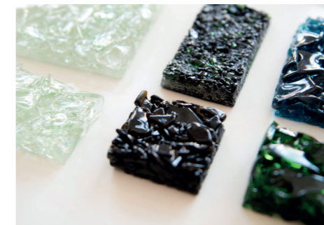
Prototyp der Glasfliesen in unterschiedlichen Formaten © Wojciech Zawarski
