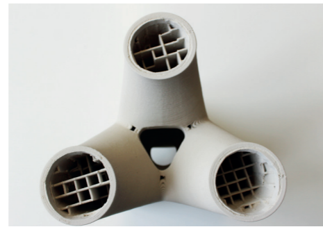
Sicht auf die innere Stützstruktur © Sandra Böhm
