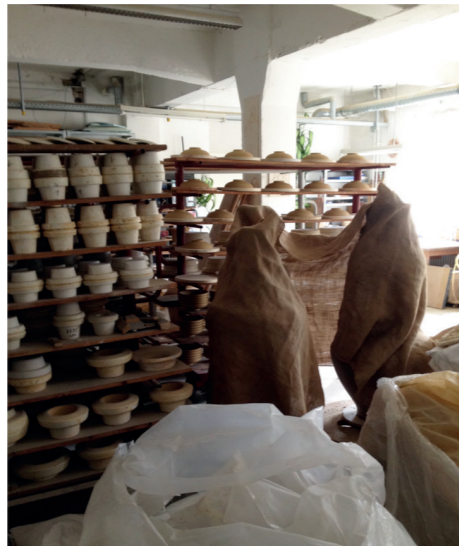
Der Trocknungsprozess wird durch Umwickeln mit Tüchern und Folien gesteuert © Sandra Böhm
