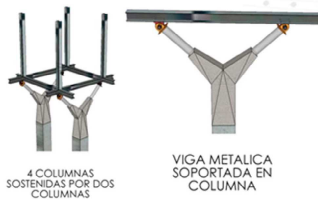
Figura 22 Detalle columna y viga
