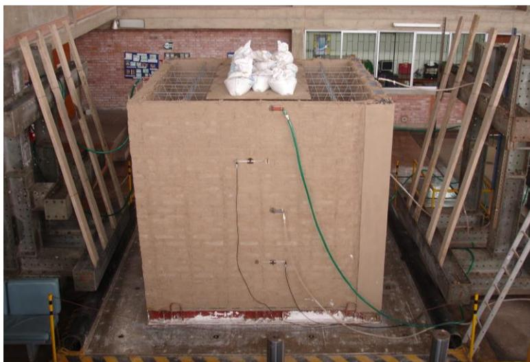
**Fig. 1.22 Modelo experimental de vivienda de adobe de dos pisos reforzada con SAI.**
