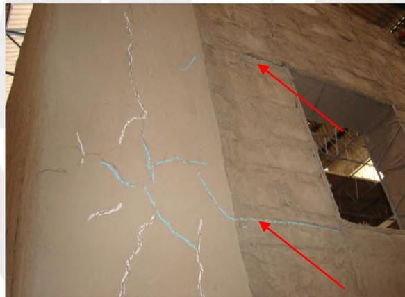
**Fig. 5.11 Muestra fisuras en ventana izquierda de segundo piso MP.**
