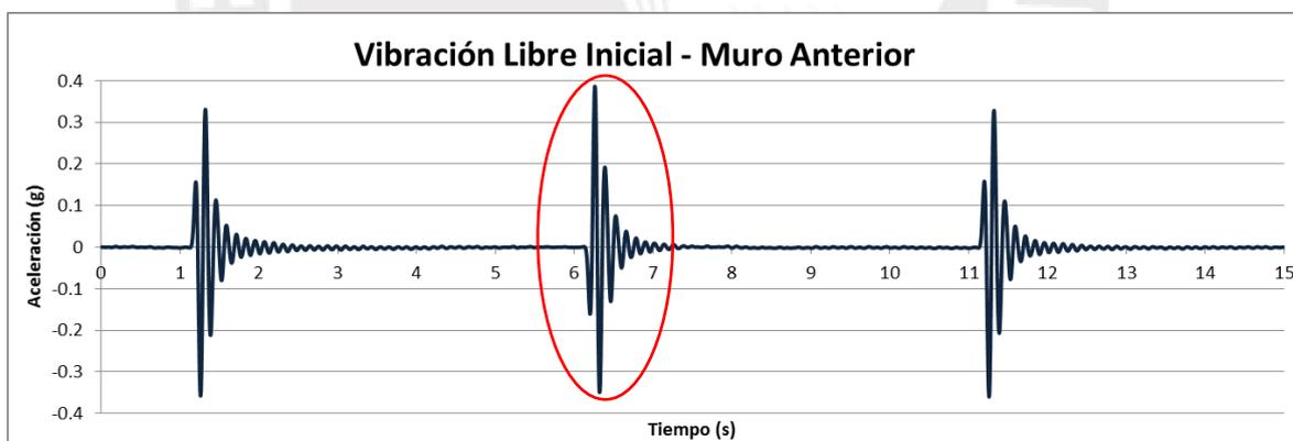
Fig. 5.1 Estructura en vibración libre y elección de intervalo de respuesta (6 a 7s).
