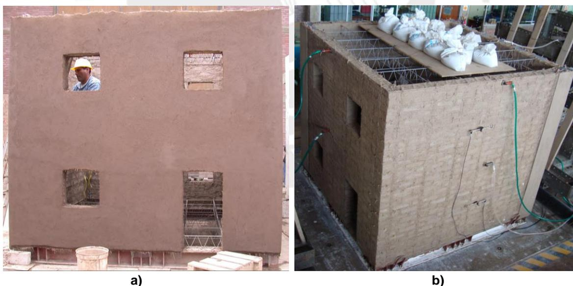
**Fig. 3.3 a) MA, durante la construcción. b) MP y MI del Modelo Experimental instalado e instrumentado sobre la mesa vibradora. (Departamento de Ingeniería Civil PUCP).**
