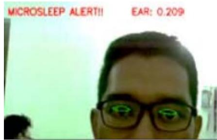
**Ilustración 8: Efecto de anteojos en el sistema de detección**
