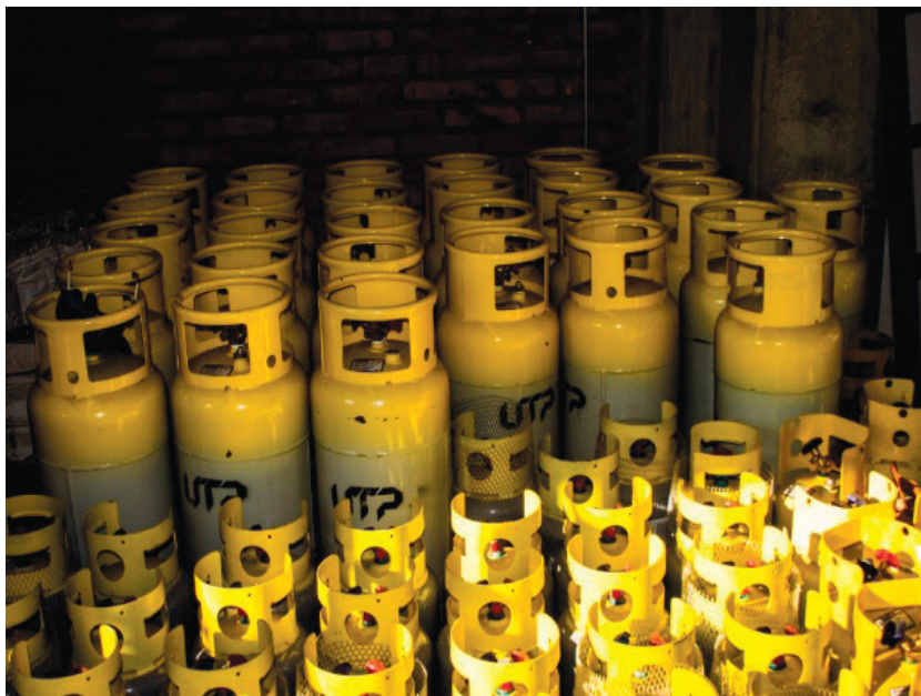
Figura 4. Cilindros UTP para regenerar gas en el CRRR-EC
