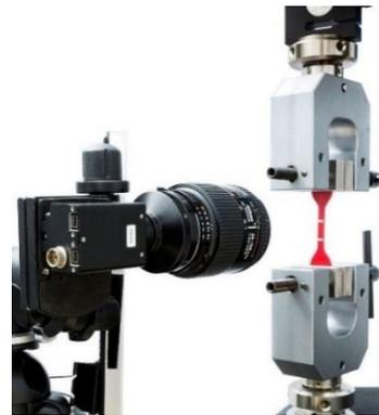
Figura 31 - Extensômetro ótico [36]
