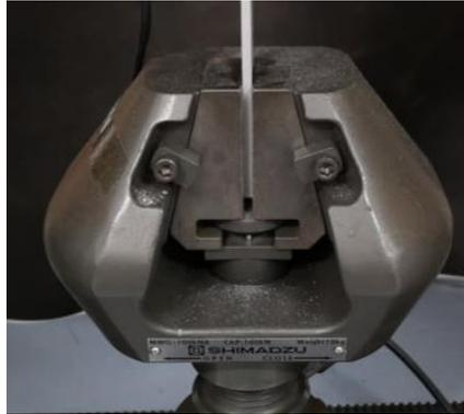
Figura 29 - Amarra de fixação dos provetes à máquina de ensaio - Fonte: Elaborada pelo autor
