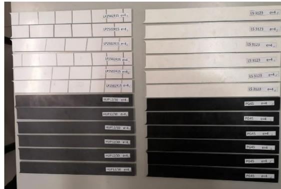
Figura 60 - Provetes após corte, respetivamente catalogados pelo material e espessura
