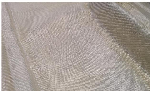
Figura 17 - Pré-forma em fibra de aramida - Fonte: Elaborada pelo autor
