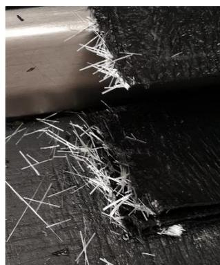
Figura 15 - Fibras de vidros impregnadas com 20 a 25 mm de comprimento no SMC - Fonte: Elaborada pelo autor
