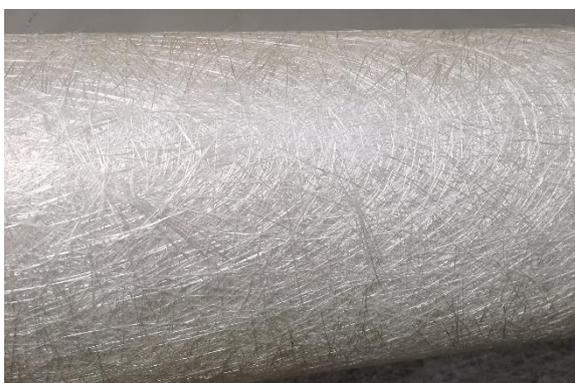
Figura 14 - Manta de fibras de vidro contínuas -
