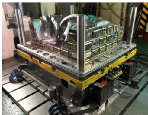
Figura 21 - Punção molde de compressão - Fonte: Elaborada pelo autor
