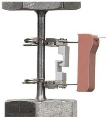
Figura 30 - Extensômetro mecânico [36]
