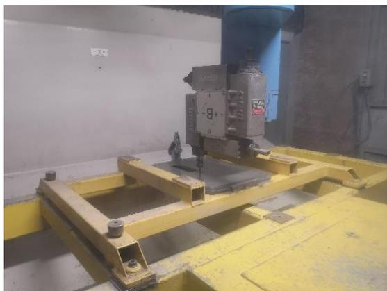
Figura 59 - Tabuleiro na máquina de corte, *Belotti*, durante a maquinação dos provetes
