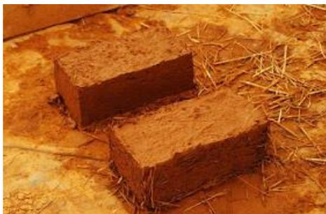
Figura 4 - Tijolos de Argila reforçados com palha [4]
