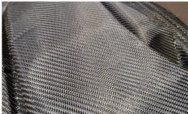
Figura 16 - Pré-forma em fibra de carbono - Fonte: Elaborada pelo autor
