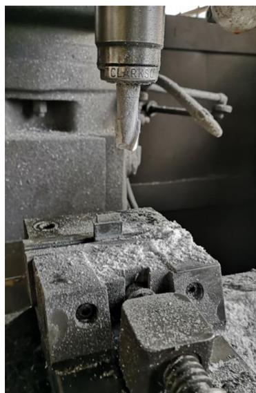
Figura 62 - Fresadora manual utilizada para o corte dos provetes do ensaio de corte
