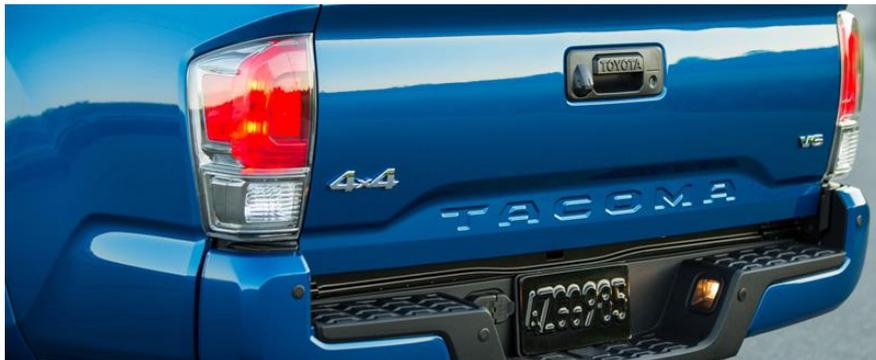
Figura 3 - Painel exterior de carroçaria SMC - classe A [1]
