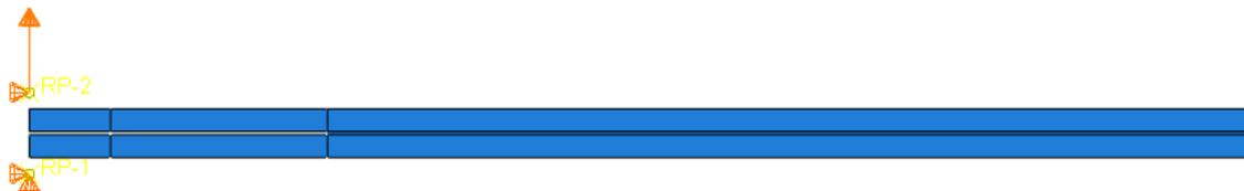
Figura 116 - Parâmetros de simulação - condições fronteira do provete DCB
