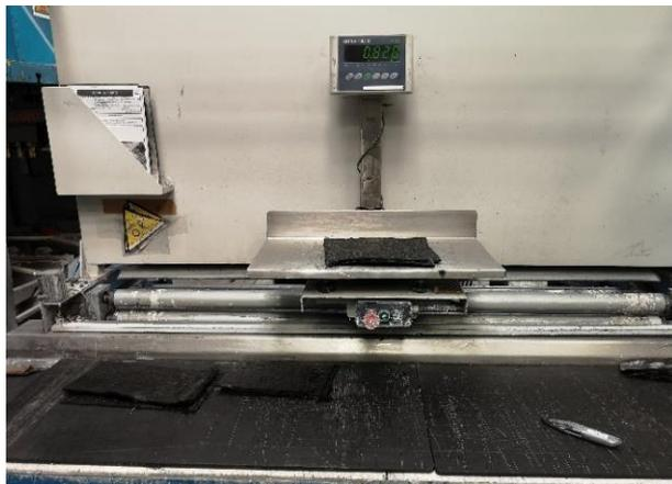
Figura 58 - Banca de preparação de carga - Corte e pesagem da carga
