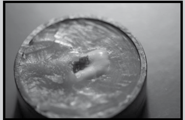
RYS. 2. Ząb stabilizowany woskiem w tulei badawczej do badań wytrzymałościowych. FIG. 2. A tooth stabilized in an examination sleeve with wax used for strength tests.
