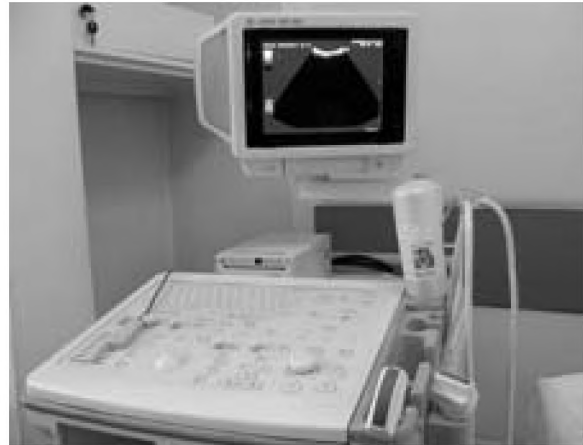
Figure 6. US unit: General Electric LogiQ 400 with video capture system. Rycina 6. Ultrasonograf General Electric LogiQ 400 z systemem cyfrowej akwizycji obrazów („video capture”).
