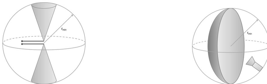
**Abb. 7.26** Verdeutlichung der Bemessung von  $r_{min}$  anhand zweier Antennentypen.
