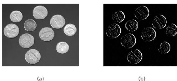
**Figura 4.9** Efecto de convolucionar (a) con un kernel de Sobel.
