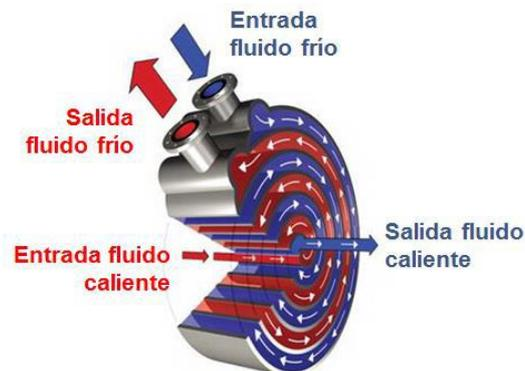
Ilustración 21: Intercambiador de espiral. [16]
