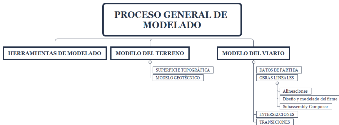
Ilustración 32. Proceso General de modelado. Fuente: Elaboración propia.
