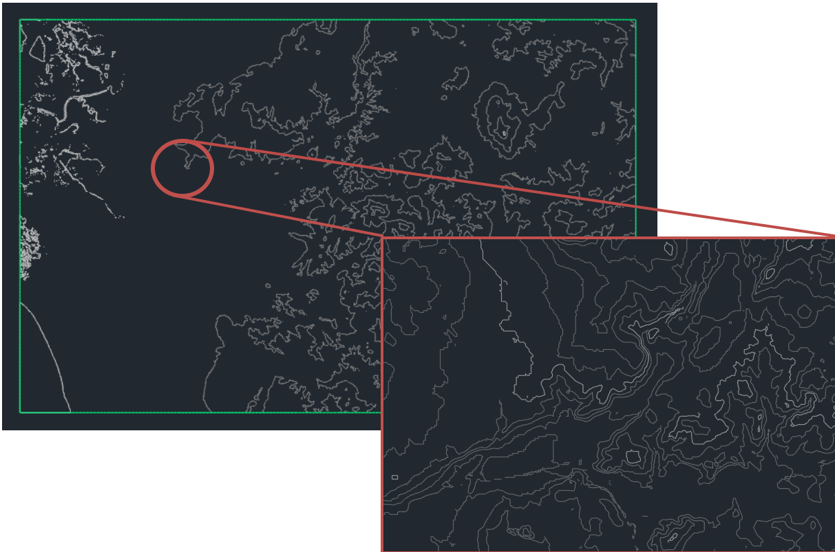
Ilustración 41. Superficie topográfica generada a partir del CNIG. Fuente: Elaboración propia.
