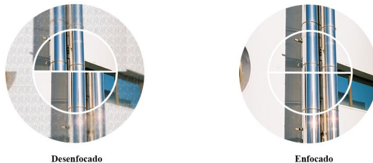
Figura 21. Combinación del enfoque tipo microprisma y tipo imagen partida. Fuente: Elaboración propia.
