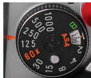
Figura 8. Rueda de velocidad de obturación de una cámara réflex. Fuente: Elaboración propia.
