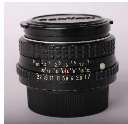
Figura 7. Objetivo fijo en el que se pueden apreciar sus diferentes escalas. Fuente: Elaboración propia.
