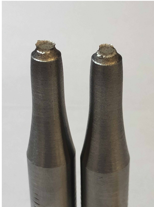
FIGURA 6.7: Superficies de fractura de una probeta entallada después de un ensayo de tracción.
