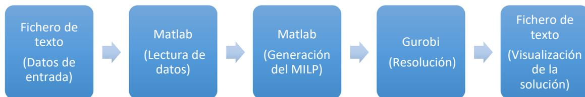
**Figura 4.3** Funcionamiento de ejecución.
