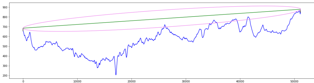
Figura 9 - Representación completa del perfil con antenas, rayo y elipsoide de Fresnel.
