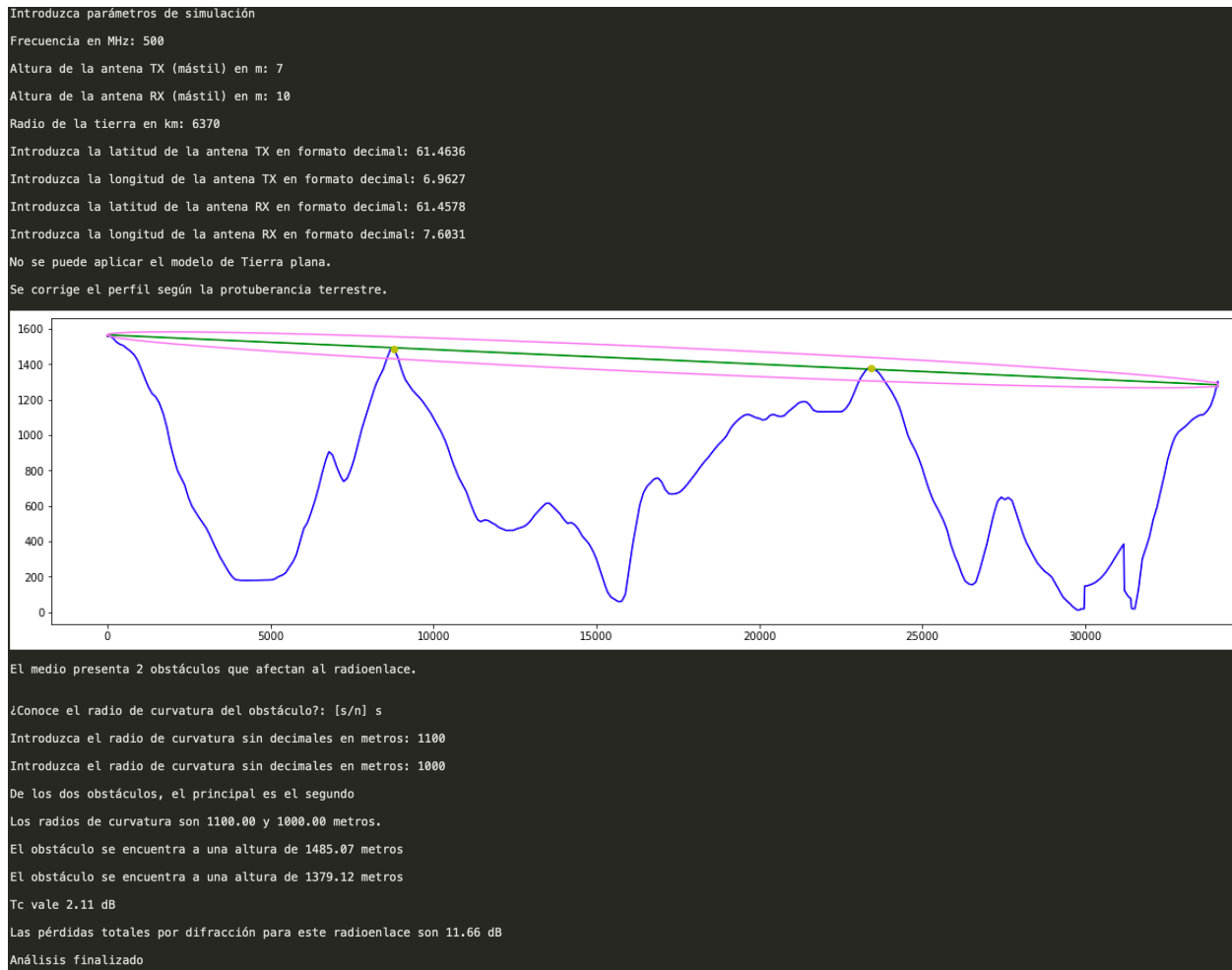
Figura 42 - Simulación de radioenlace con dos obstáculos redondeados
