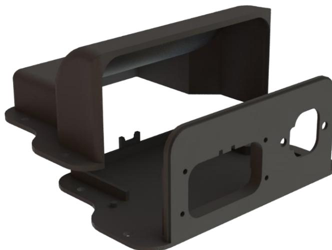
Figura 4.12 – Visualização em CAD da caixa impressa em 3D.
