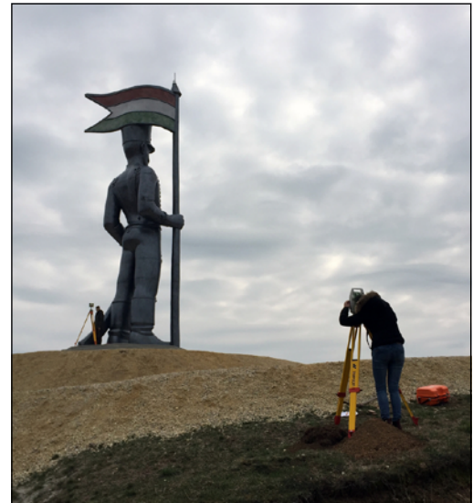
14. ábra. Őrhálózat mérése Miska huszár szobránál
