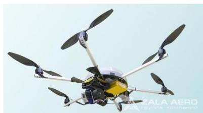
Рисунок 5 – Беспилотный летательный вертолёт. Модель «ZALA-421-21»
