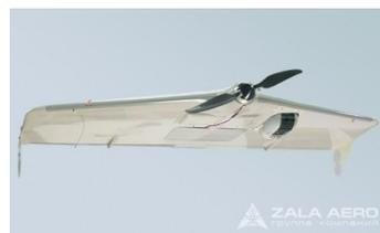
Рисунок 6 – Беспилотный летательный самолёт. Модель «ZALA-421-08М»
