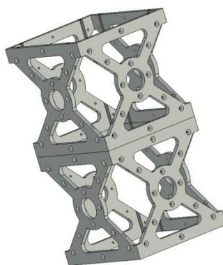
Рисунок 1 – Корпус спутника формата CubeSat 2U
