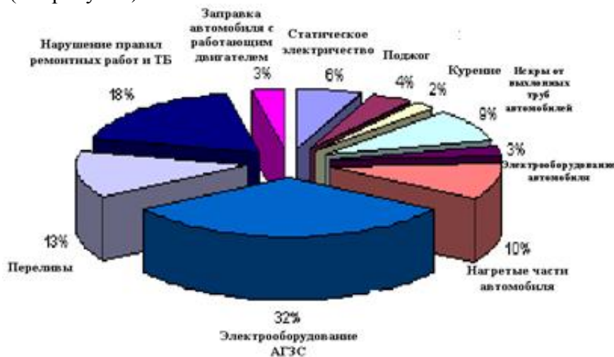
Рисунок – Причины аварий на автомобильной газозаправочной станции
