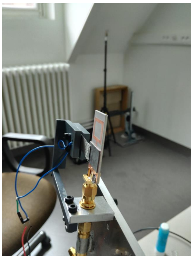
Рис. 4.32. Експериментальній стенд та виготовлена антена: а) перший режим роботи; б) другий режим роботи
