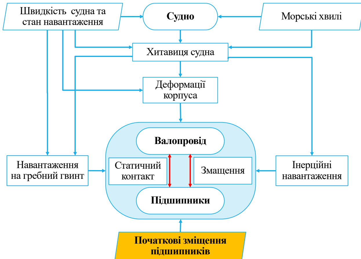
Рисунок 5.1 — Схема математичної моделі роботи валопроводу у складі корпусу судна
