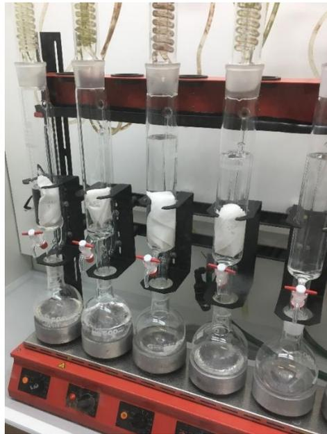
Figura 19. Extrator de Soxhlet
