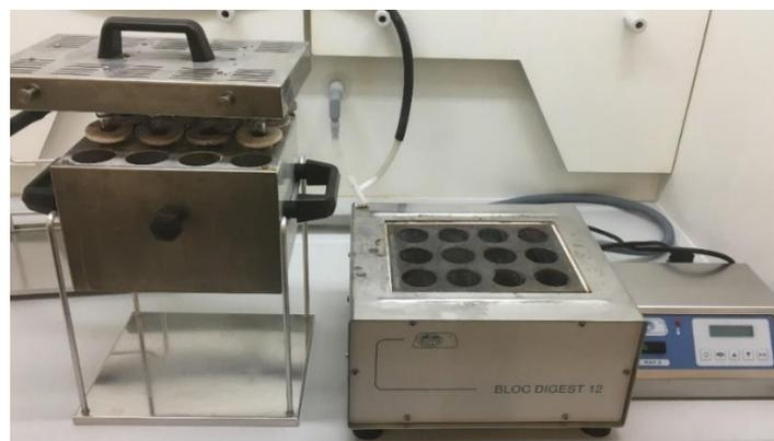
Figura 20. Digestor para proteínas
