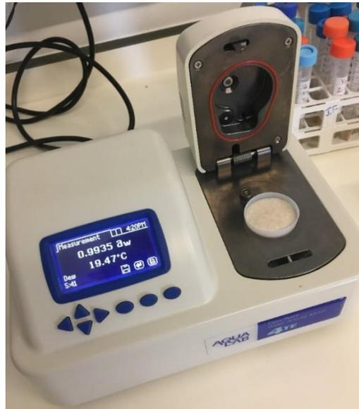
Figura 17. Medidor de atividade de água
