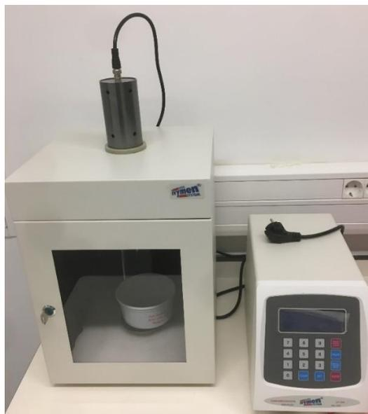
Figura 10. Equipamento de extração assistida por ultrassons
