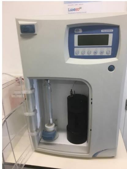
Figura 21. Destilador Kjeldahl
