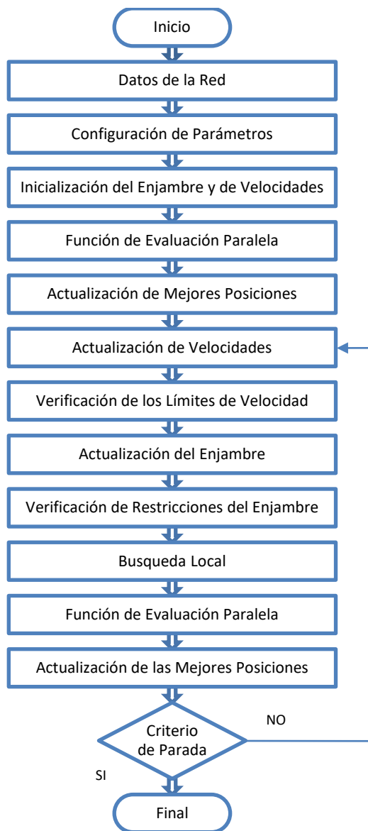
Fig. 2. Diagrama de flujo del Algoritmo Memético para resolver el PDEST.
