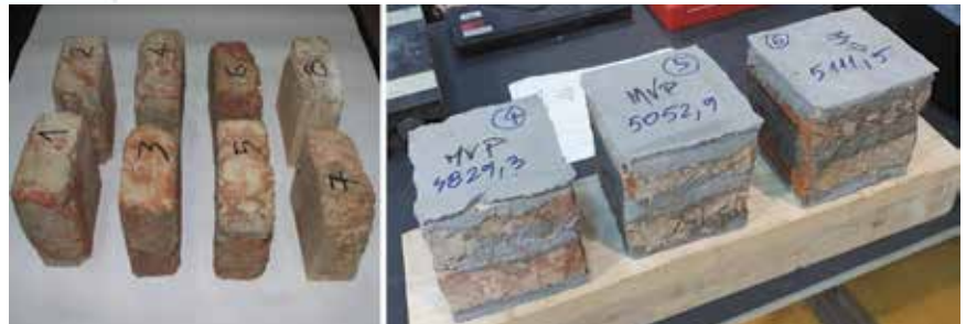
Slika 12. Uzorci opeke uzeti za ispitivanje tlačne čvrstoće i uzorci nakon pripreme za ispitivanje
