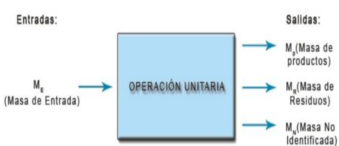
Figura 1. Esquema ilustrativo de un balance de masa.
