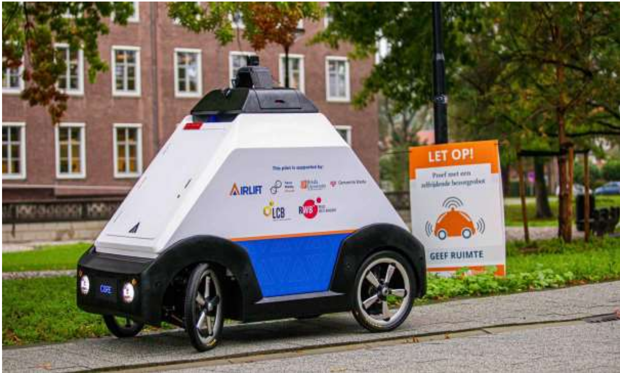
Figure 1: The automated logistics robot LoWIE (Logistiek op WIElen). Its presence is indicated using the signs with the text "Let op, proef met een zelfrijdende bezorgrobot. Geef ruimte!"
