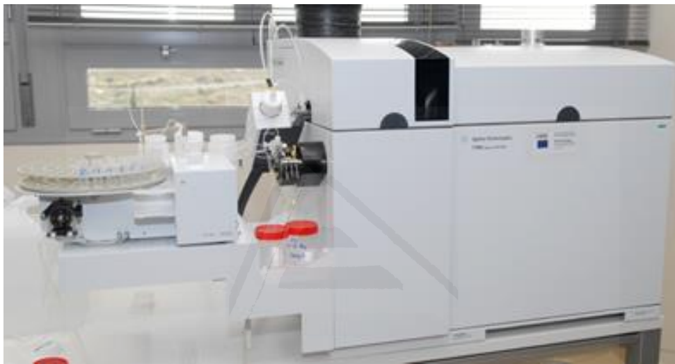
Figura I.2. Equipo ICP-MS empleado para la determinación del contenido en fósforo en las muestras de almidón, situado en los Servicios Técnicos de Investigación de la Universidad de Alicante. Imagen reproducida literalmente de su página web.
