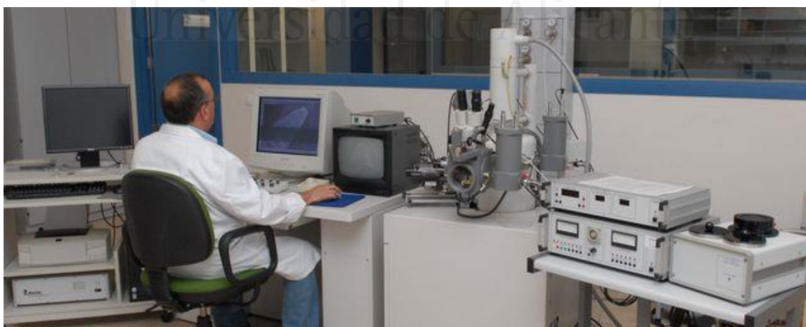
Figura I.1. Disposición horizontal del microscopio de barrido situado en los Servicios Técnicos de Investigación de la Universidad de Alicante. Imagen reproducida literalmente de su página web.
