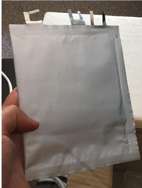
Figura 77 Prototipo de condensador escalado a 100 cm 2 en bolsa flexible
