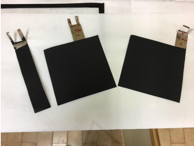
Figura 72 Electrodo preparados para el prototipo escalado a 100 cm 2
