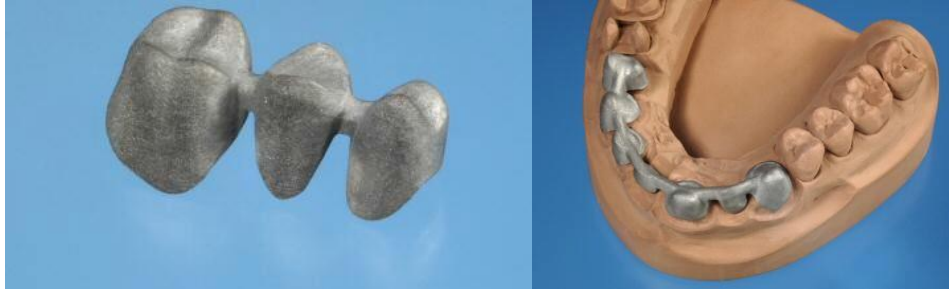
Resim 4: Doğrudan Metal Lazer Sinterleme (DMLS) CoCrMo alaşımının dişilik uygulaması [5]
