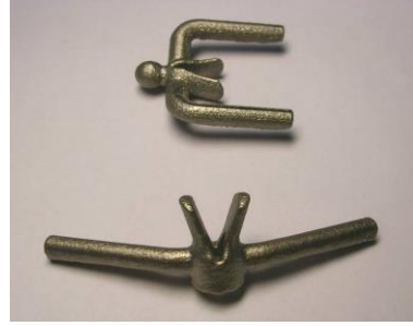
Resim 7. CoCrMo diz protezi ve Ti64 bel implantı [4]
