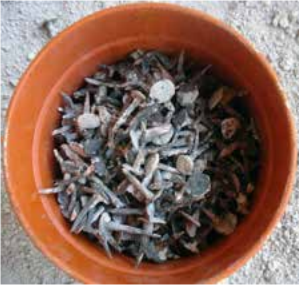
Fotoğraf 29. Özelliğini yitirmiş ve paslanmış demir çiviler
