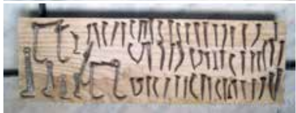
Fotoğraf 66-67. Kepenkler üzerinden sökülen metal elemanlar
