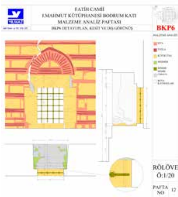
Çizim 2-3. Restorasyon uygulaması sırasında hazırlanan malzeme ve hasar tespit paftaları
