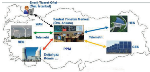
Şekil 5: Coğrafi olarak geniş bir alana yayılmış üretim tesislerinin merkezden veya uzaktaki operatörler tarafından izlenmesi ve kumandası
