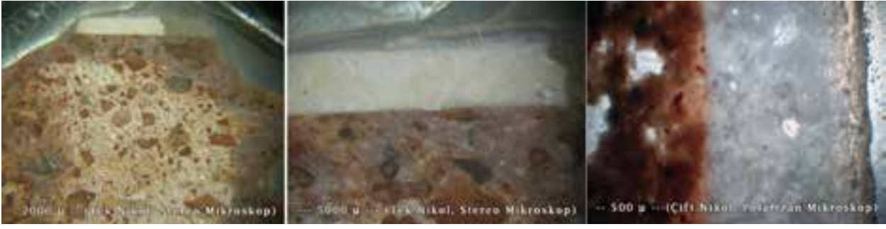
Fotoğraf 1. Örnek 1'in genel dokusu ve yüzeyindeki bitim (üst) sıvası. Kireç bağlayıcı içeriğinde bulunan tuğla-keramik kırıkları ve tozu ile kalsit, kırıntı, siyah cüruf parçacıkları ve üst (bitim) sıva yüzeyindeki boya tabakaları.
