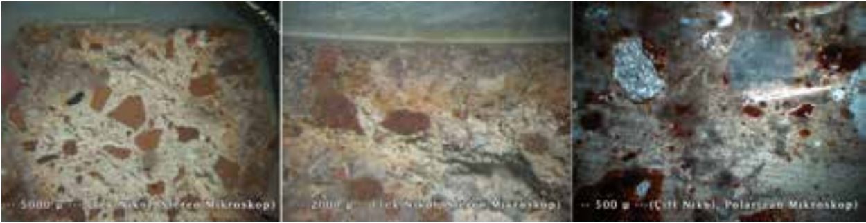
Fotoğraf 3. Örnek 10'un genel dokusu ve yüzeyinde bulunan boya tabakası. Kireç bağlayıcı içeriğinde bulunan tuğla kırıkları ve tozu ile kalsit, kuvars ve siyah cüruf parçacıkları.
