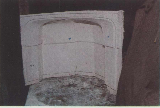
Resim 34-35: Alçı mukarnasların montajdan önceki rotuşları atölyede yapılmış, daha sonra montaja geçilmiştir.
