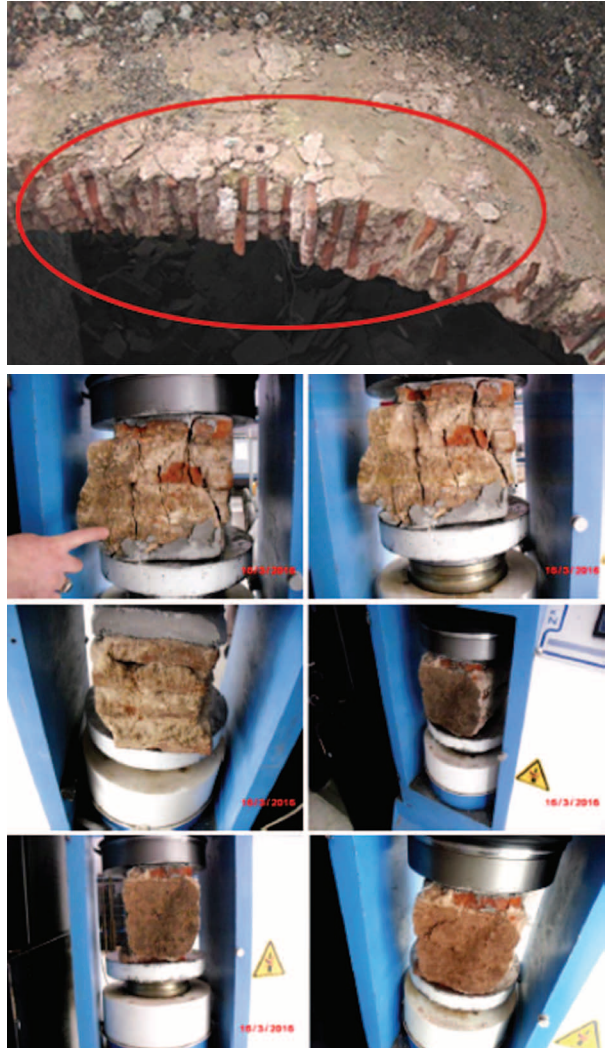
Fotoğraf 1. Edirne Ekmekçizade Kervansarayı tonozundan alınan prizma numunelerin tek eksenli basınç deneyi.
