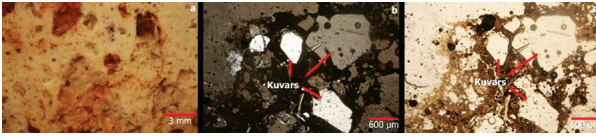
Fotoğraf 10. Taş-4 kodlu örneğin a) stereo mikroskop altındaki ve polarizan mikroskop altındaki b) çift nikol, c) tek nikol görüntüleri.
