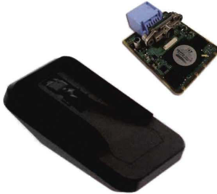
Figure 3.1 : Caméra principale de Mobileye 5
