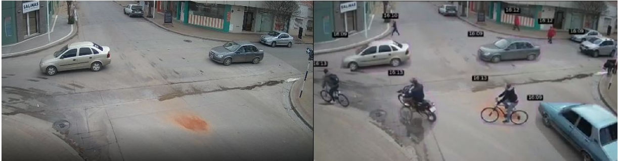
Fig. 7. Capturas instantáneas del antes y después de aplicar la técnica de sinopsis de video o video resumen.
