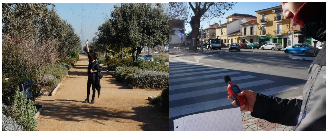
Figuras 3.11 y 3.12. Toma de medidas con sonómetros en diferentes puntos de la ciudad.
