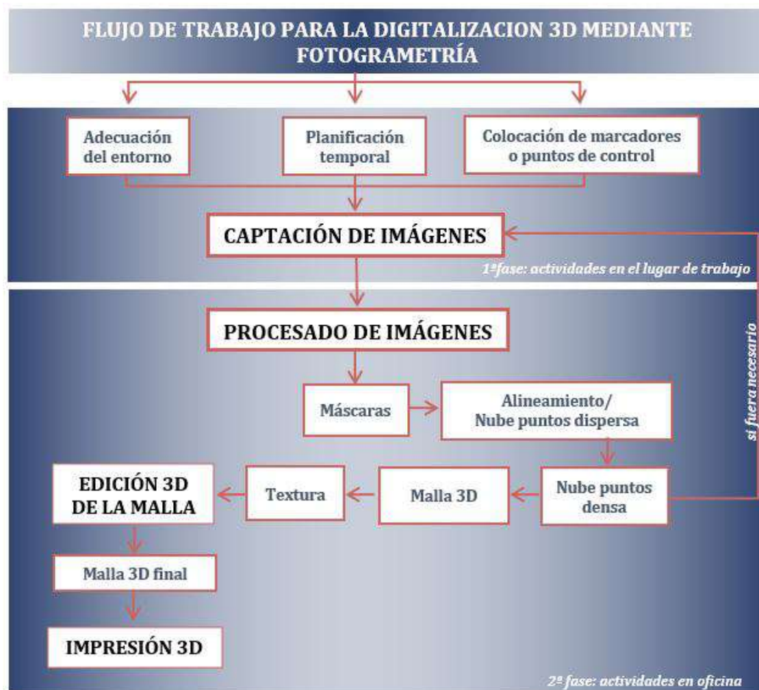
Ilustración 8. Diagrama del flujo de trabajo para la digitalización 3D mediante fotogrametría digital (Fuente: Elaboración propia).
