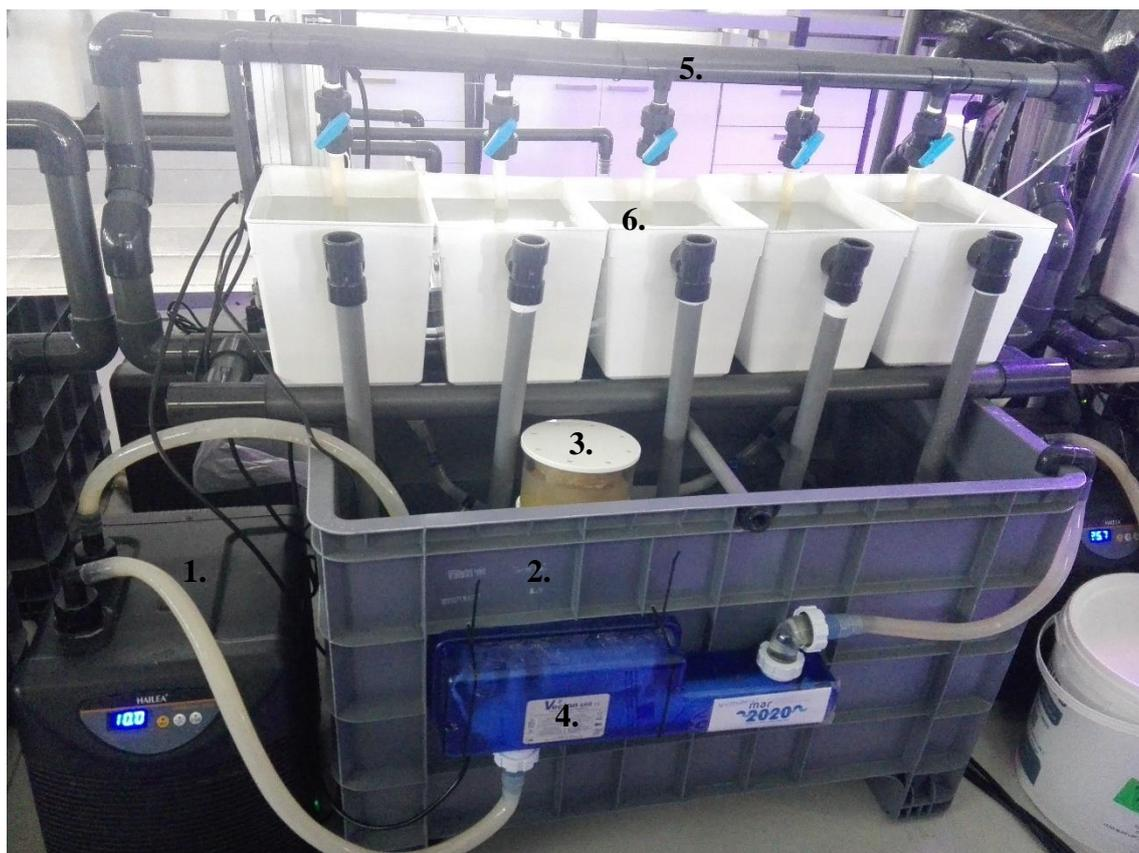
Figura 2: Um dos sistemas de depuração utilizados com: um refrigerador (1), um tanque de 250 litros (2), um escumador de proteínas (3), um filtro UV (4) e um sistema de suporte de PVC (5) para os 5 tanques de 15 litros (6) onde se encontravam os lingueirões.
