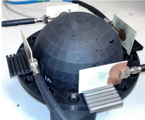
Figura 4.19: Sistema de medida com quatro antenas
