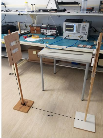
Figura 3.24: Setup, usado em laboratório, para medição do  $S_{21}$
