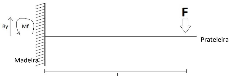
Figura 107: Esquema do funcionamento das forças na prateleira
